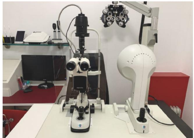
▲ Bild 3 | Schutzschild, angebracht an einer Spaltlampe als Schutz vor Atemtröpfchen
